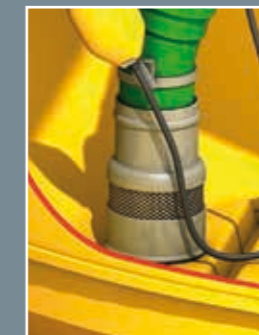
2 Stufe 2 Einlaufberuhigung verhindert Sedimentaufwirbelung und verteilt das frische, sauerstoffreiche Wasser im Speicher
