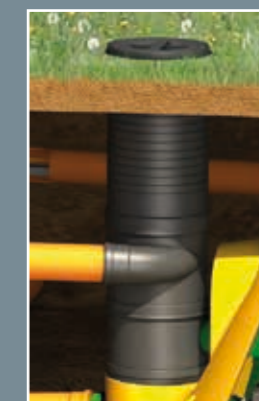
1 Stufe 1 Wirbel-Fein-Filter zur Schmutz- abtrennung und Sauerstoffanreicherung
